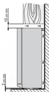
Не закрывайте вентиляционный проем в верхней части холодильного прибора – вокруг прибора должна быть хорошая циркуляция воздуха. Между верхней частью корпуса холодильного прибора и находящейся над ним мебелью оставьте промежуток не менее 10 см. При несоблюдении данного требования холодильник потребляет больше электроэнергии, может перегреться компрессор холодильника.
